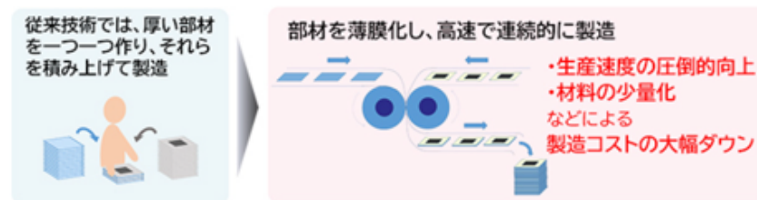
図1 水電解用セルスタックの低コスト製造（イメージ図）
