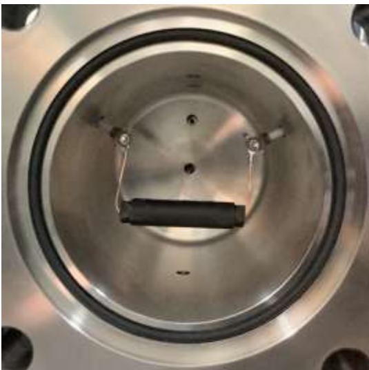
図IV 圧力容器へのテストセルの設置
