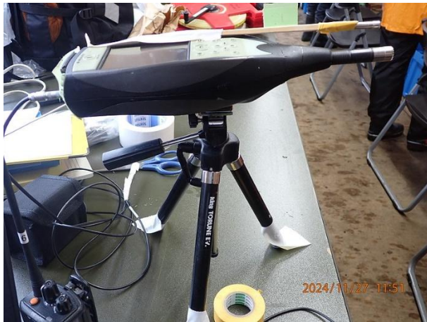
図 4.1.2.3-11 観測所屋内のマイクロフォン ch2 と騒音計 ch3
