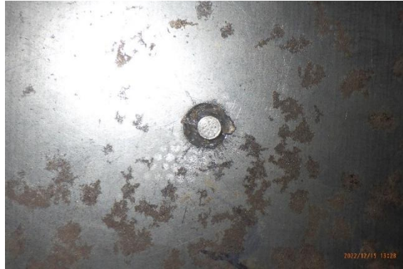
図 5-10 実験台に固定した圧力センサー
