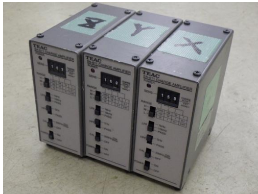
図. 4.1.2.3-5 加速度センサーのアンプ TEAC SA-611
