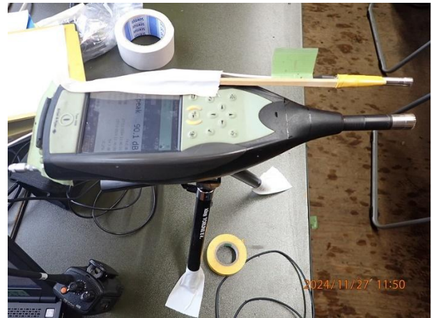
図 4.1.2.3-11 観測所屋内のマイクロフォン ch2 と騒音計 ch3
