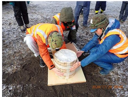
図 4.1.2.1-4 装薬・爆装状況 (実験 No.1-4 の例)
