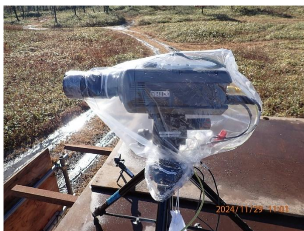
観測所1の屋上に設置して爆点を撮影する高速度カメラ
