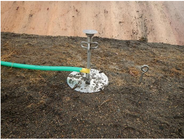
爆風計測架台
