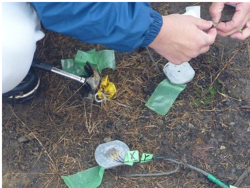
図. 4.1.2.3-4 加速度センサー設置の様子
