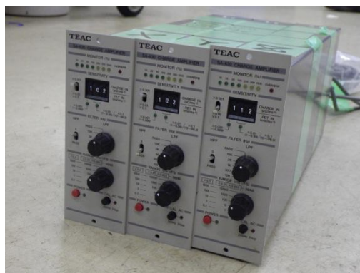
図. 4.1.2.3-6 加速度センサーのアンプ TEAC SA-630
