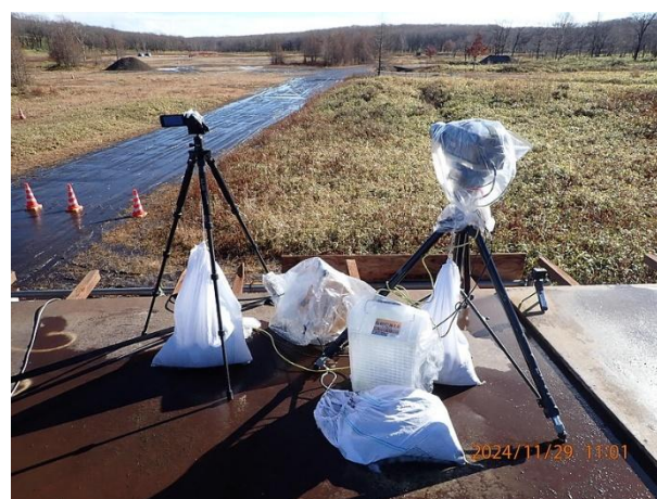
観測所1の屋上に設置して爆点を撮影する高速度カメラ
