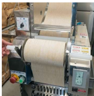
米麺を生産するロール式製麺機麺帯
