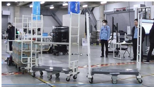
図：試験№115 サウザー、2段積みケース短辺をW方向に2列並べる (20kg/ケース×12ケース = 総重量240kg) + 空カートラック×2台、90度
