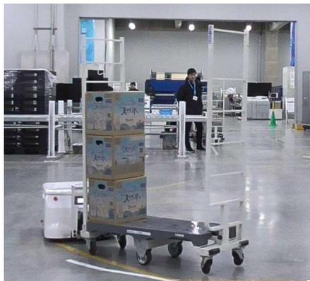
図：試験№75 シグナス、前、空3段積みL1列 (20kg/ケース×3ケース=総重量60kg)、180度
