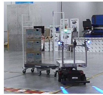
図：試験№85 サウザー、3段積みL1列 (20kg/ケース×3ケース=総重量60kg)、90度
