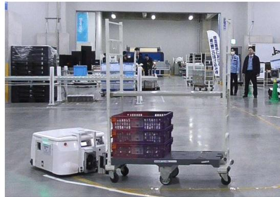
図：試験№81 シグナス、前、3段積みL1列 (1オリコンあたり2ℓペットボトル5本入れる=約10kg/クレート×3クレート=総重量30kg)、180度
