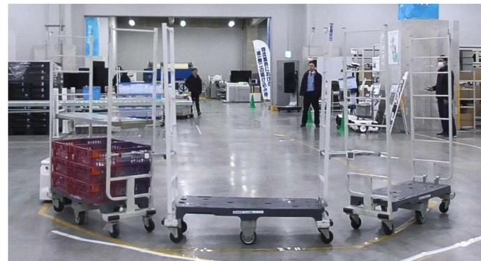
図：試験№120 シグナス、3段積みクレート長辺をW方向に1列 (1クレートあたり2ℓペットボトル5本入れる=約10kg/クレート×6クレート=総重量60kg) + 空カートラック×2台、180度
