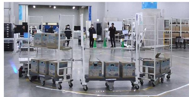
図：試験№34 サウザー、1台目2ℓペットボトル（20kg／ケース）×5ケース、2～3台目2ℓペットボトル（20kg／ケース）×3ケース
