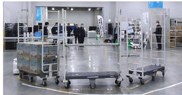
図：試験№114 シグナス、2段積みケース短辺をW方向に2列並べる (20kg/ケース×12ケース = 総重量240kg) + 空カートラック×2台、180度
