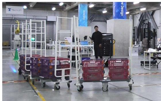
図：サウザー、0.5m/ms（低速）、6クレート×カートラック3台
