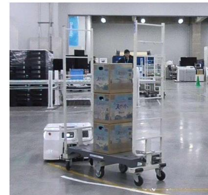
図：試験№93 シグナス、真ん中、3段積みL1列 (20kg/ケース×3ケース=総重量60kg)、180度
