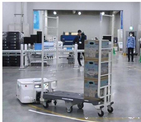
図：試験№84 シグナス、後、空3段積みL1列 (20kg/ケース×3ケース=総重量60kg)、180度
