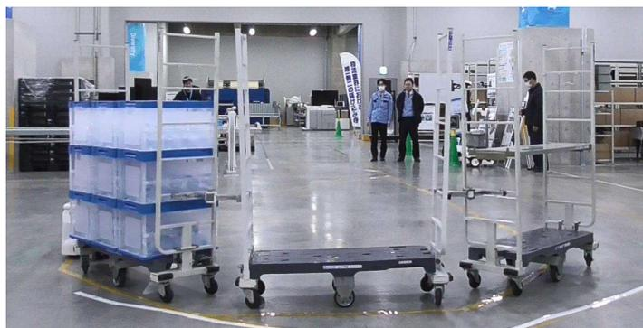
図：試験№117 シグナス、3段積みオリコン長辺をW方向に1列 (1オリコンあたり2ℓペットボトル7本入れる=約15kg/オリコン×9オリコン=総重量135kg) + 空カートラック×2台、180度
