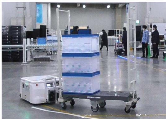
図：試験№78 シグナス、前、3段積みL1列 (1オリコンあたり2ℓペットボトル7本入れる=約15kg/オリコン×3オリコン=総重量45kg)、180度
