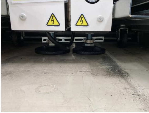
設備を金具で連結していたため、ずれ防止となった（左）、ラックの柵が製品の落下を防止した（右）
