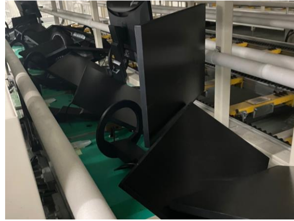
設備を金具で連結していたため、ずれ防止となった（左）、ラックの柵が製品の落下を防止した（右）
