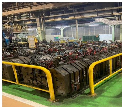
高重心金型は2点フックで固定（左）、低重心金型はエリアを定めて固定（右） することで被害を受けなかった
