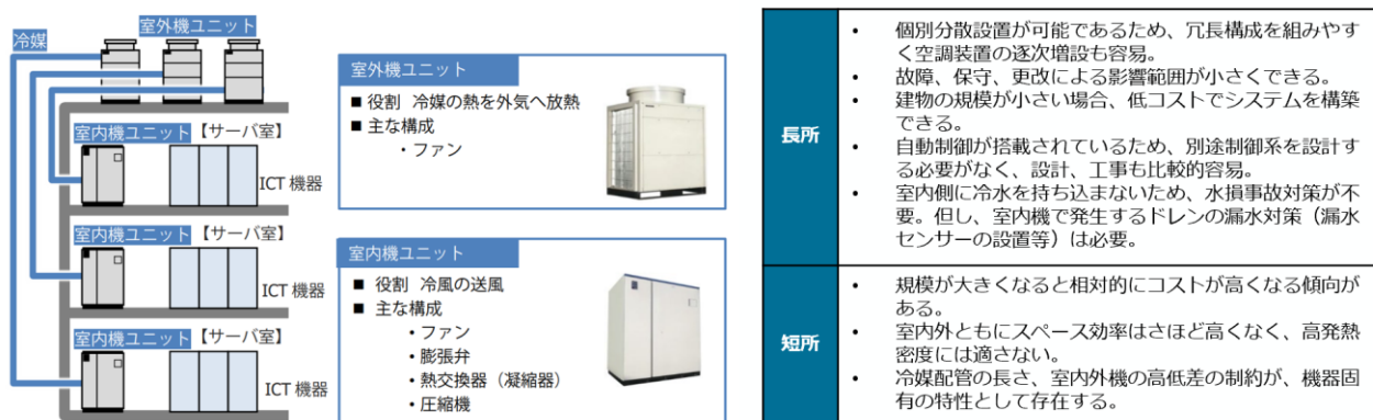
図表 2-43 パッケージ空調の設備構成と特徴
