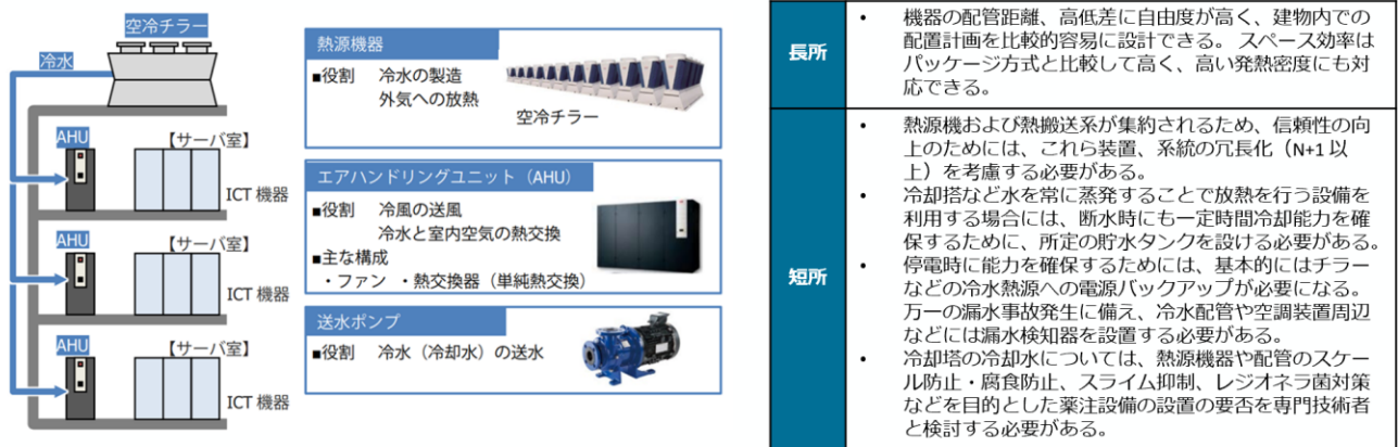
図表 2-44 AHU の設備構成と特徴
