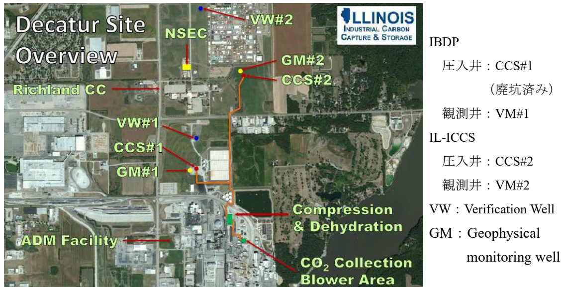
図 3-9 IL-ICCS の圧入井 CCS#2 と周辺の設備 9
