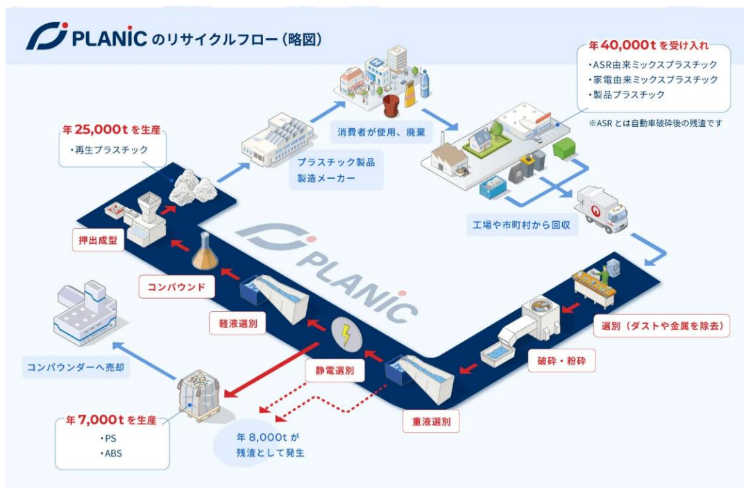
図 1-10 プラニック御前崎工場のリサイクルフロー図
