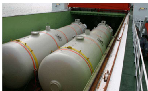
図 6-8 Stade 発電所から SWT への海上輸送中の蒸気発生器
