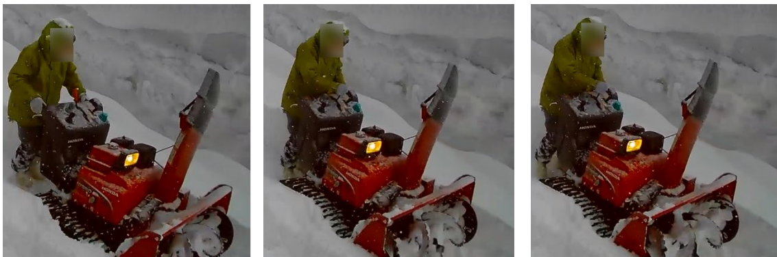
図 65 後進から前進操作 2
