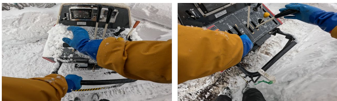
図 67 デッドマンクラッチ利用と無効化事例（右図が無効化）
