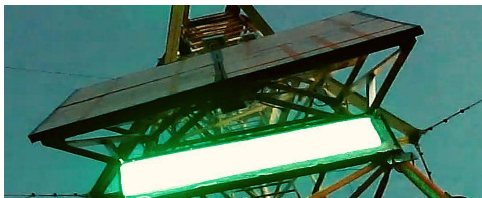
図 2-2 MIT の HUSIR 送信機を用いて実施されたマイクロ波送電による LED 点灯実験(Credit : NRL)
