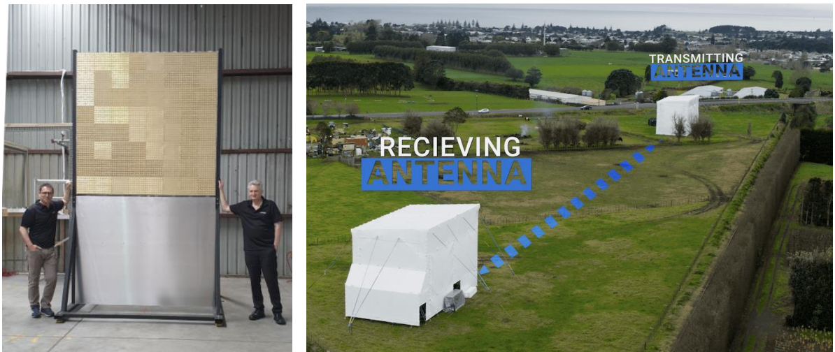
図 2-7 2021 年 5 月に実施した屋内試験のプロトタイプアンテナ(左)／2022 年 6 月に実施したフィールド試験の建屋(右) (Credit:Emrod)
