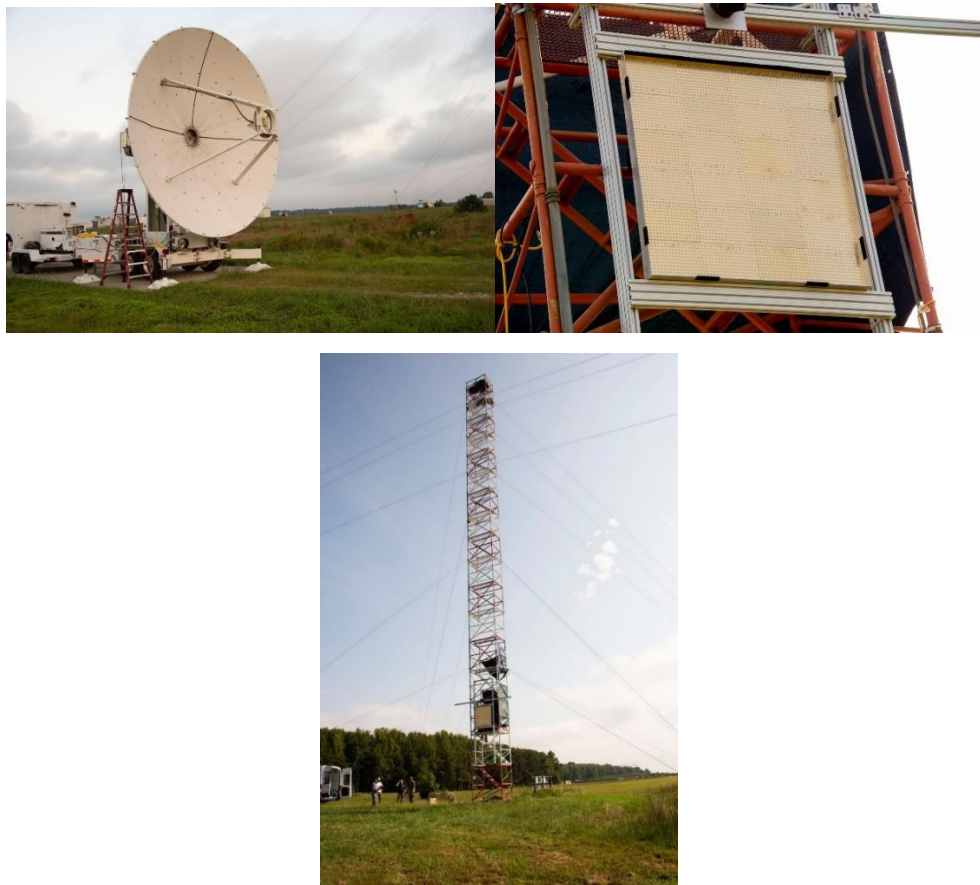
図 2-1 ブロッサムポイントで実施されたマイクロ波送電実験の送電アンテナ(左上)とレクテナ(右上と下) (Credit : NRL)
