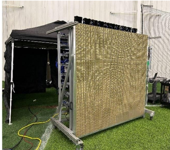
図 1-41 WPT 実験に用いられた送信アンテナのプロトタイプ
