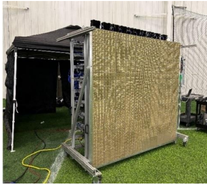
図 4-28 WPT 実験に用いられた送信アンテナのプロトタイプ
