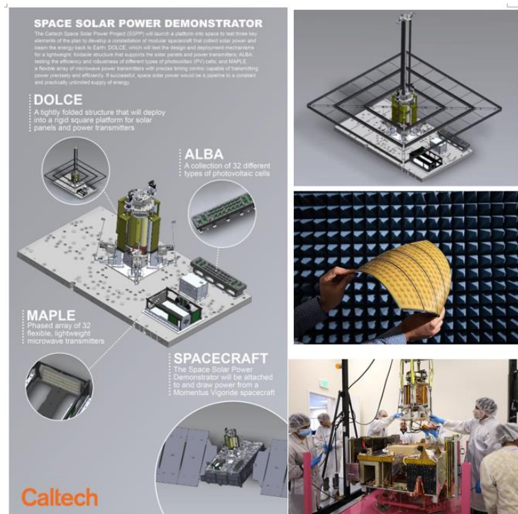
図 1-7 SSPD 実証機と構成要素(左)／DOLCE の展開実験イメージ(右上)／MAPLE のマイクロ波送電アレイのアンテナシート(右中央)／SSPD を VIGORIDE に結合する様子(右下)(Credit : Caltech)
