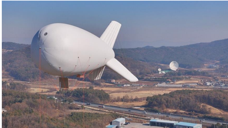
図 2-11 KARI/KERI におけるエアロスタットへの無線電力伝送実験(1.81km)
