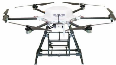
ベース機 (E6150TC) 型式認証2種 取得機 レベル3、3.5飛行可能
