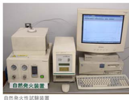
図 3.2.3-2 SIT（自然発火性試験）試験装置
