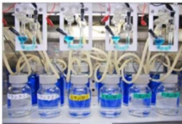
図 3.2.3-5 OxiTop 試験装置
