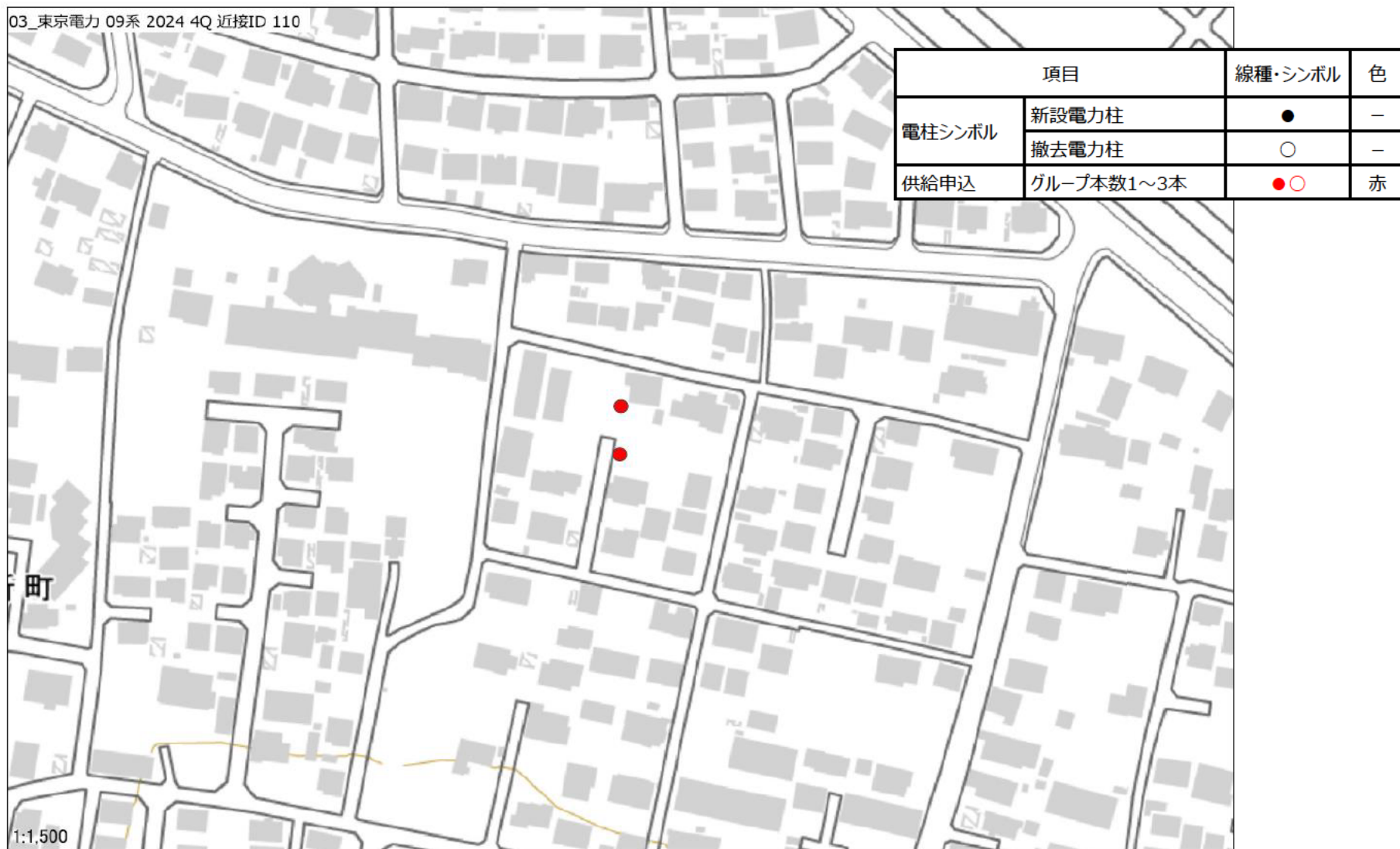
図表5-6 グループ本数1～3本①_住宅分譲地への供給申込に伴う電力柱新設
