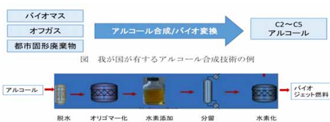
図表 44 アルコールをジェット燃料に変換するプロセス（ATJ）
