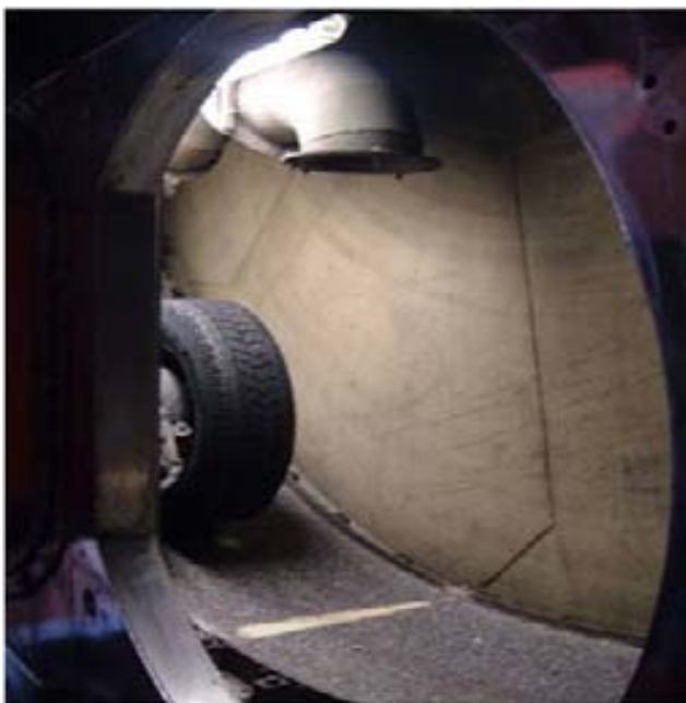
写真2 タイヤ走行シミュレータ
