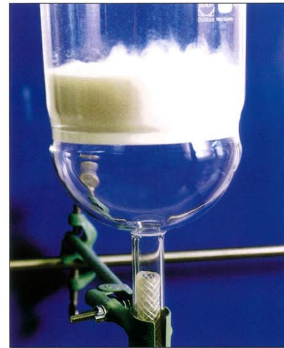
図 15: 簡単な AEROSIL® の流動化実験；半溶ガラスには約 0.2bar の圧縮空気が掛かっている。
