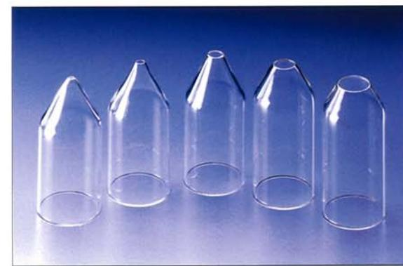
図70: 圧力を加えずに流動性を判定するための一連のテスト用じょうご
