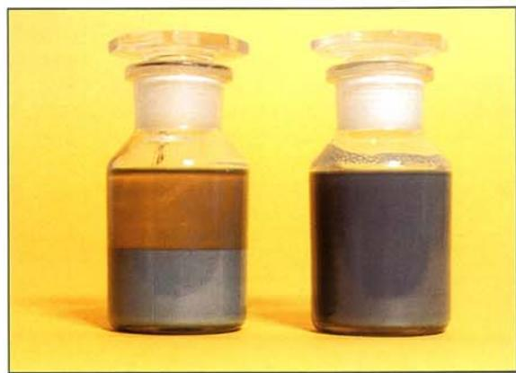
図69: 室温で4週間貯蔵後のエポキシエステル系の亜鉛末塗料の沈降の程度の比較: 左は対照用の塗料; 右は2%のAEROSIL® R972を使用した塗料; 組成: キレンに入った JÄGALYD® ED4.5% 19.6、微粒子の亜鉛末 72.5、ブタノール 1.0、SHELLSOL® A9.4、Co-octoate 6% Co 0.2
