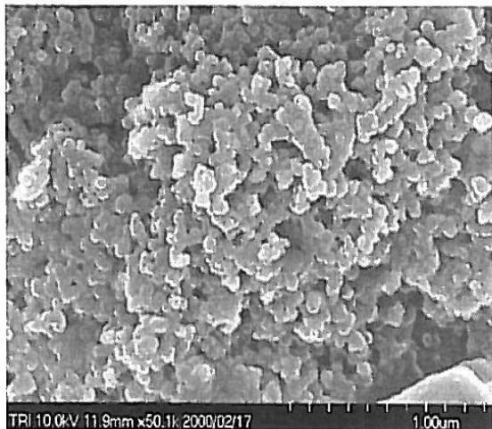
植物性油煙手焼き 原料:菜種油 菜種油を灯芯で燃焼させ、採取する。
