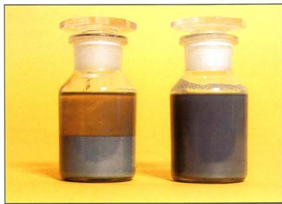
図 69: 室温で4週間貯蔵後のエポキシエステル系の亜鉛末塗料の沈降の程度の比較: 左は対照用の塗料; 右は2%の AEROSIL® R972 を使用した塗料; 組成: キシレンに入った JAGALYD® ED4.5% 19.6、微粒子の亜鉛末 72.5、ブタノール 1.0、SHELLSOL® A9.4、Co-octoate 6% Co 0.2
