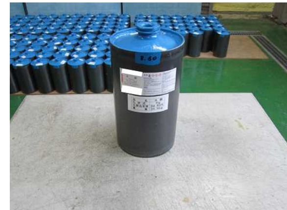
水銀を貯蔵する容器の例 (内部がエポキシ塗装された鋼鉄製容器)
