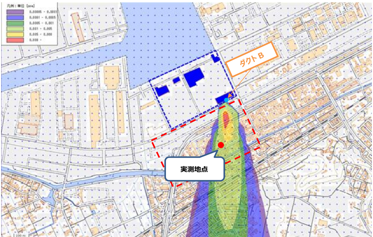
図6 ダクトBからの化学物質Bの拡散シミュレーション結果
