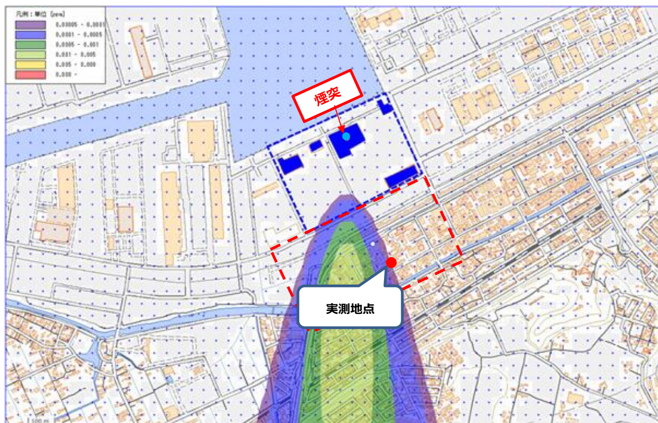
図4 煙突からの化学物質Bの拡散シミュレーション結果
