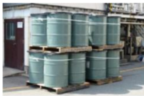
【ドラム缶平置き時の落下防止例】
