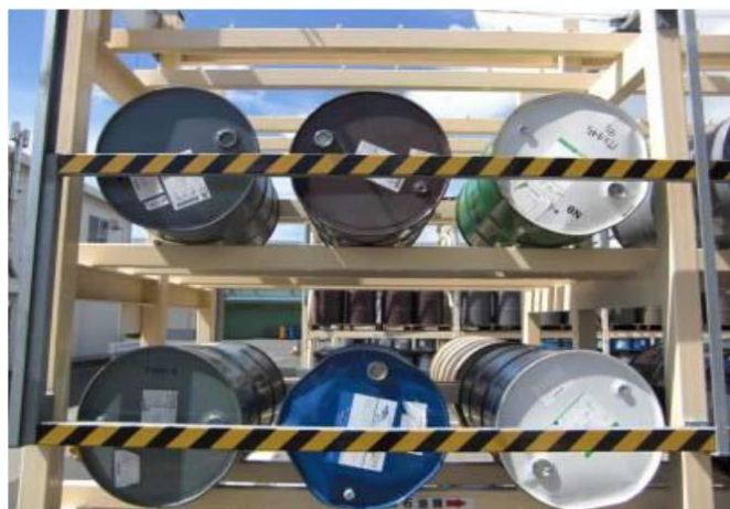
＜ドラム缶の横置き落下防止例＞
