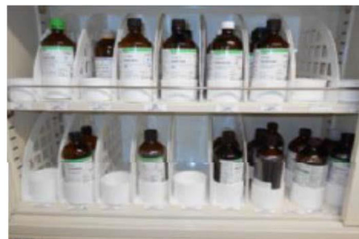
＜実験室の試薬瓶の転倒・衝突対策の例＞
