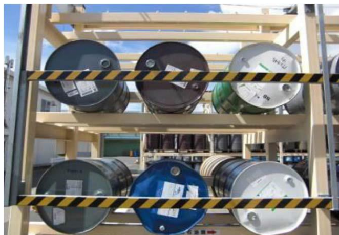
<ドラム缶の横置き落下防止例>
