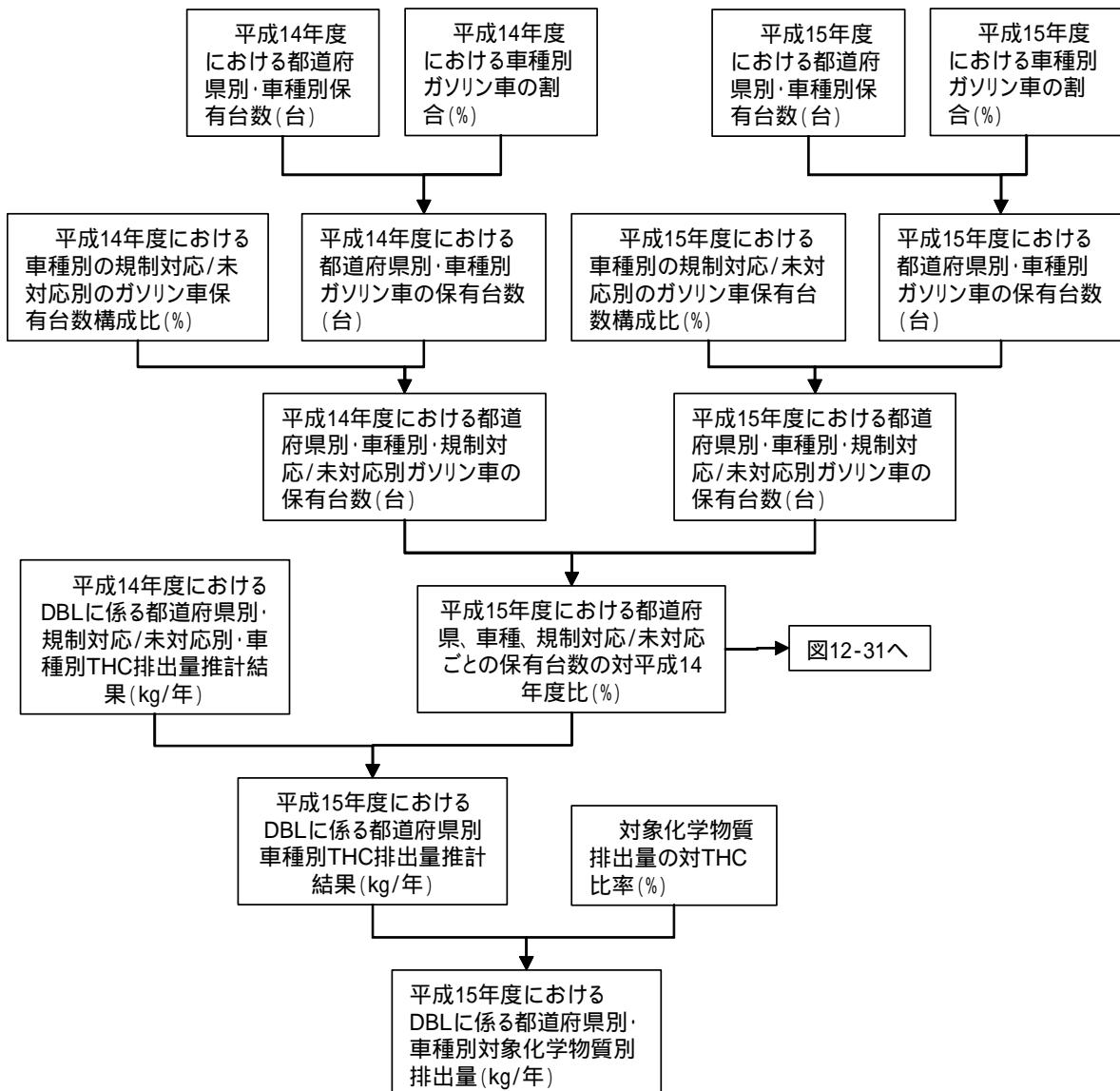
図 12-34 燃料蒸発ガス(DBL)に係る対象化学物質別排出量の推計フロー
