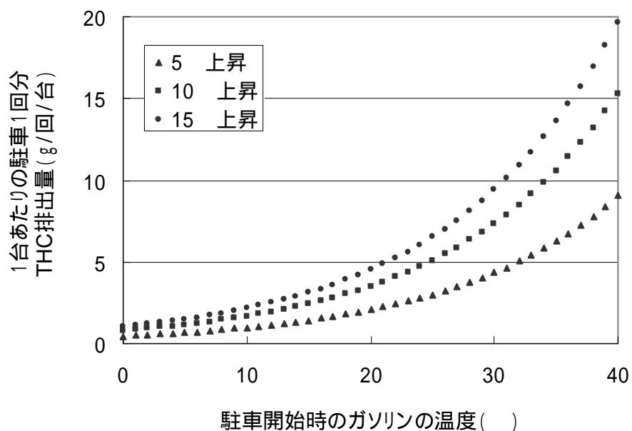
注:普通乗用車のタンク空隙容積及び夏日のリード蒸気圧(65kPa)を採用して推計した。
