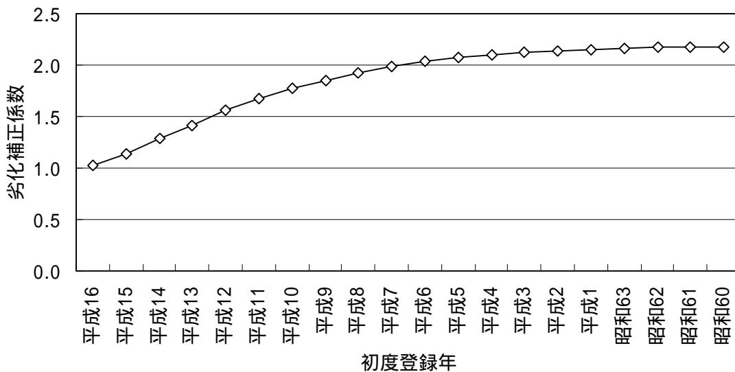
注:積算走行距離当たり劣化補正係数の増加率及び平均積算走行距離(図 12-10)に基づく推計
