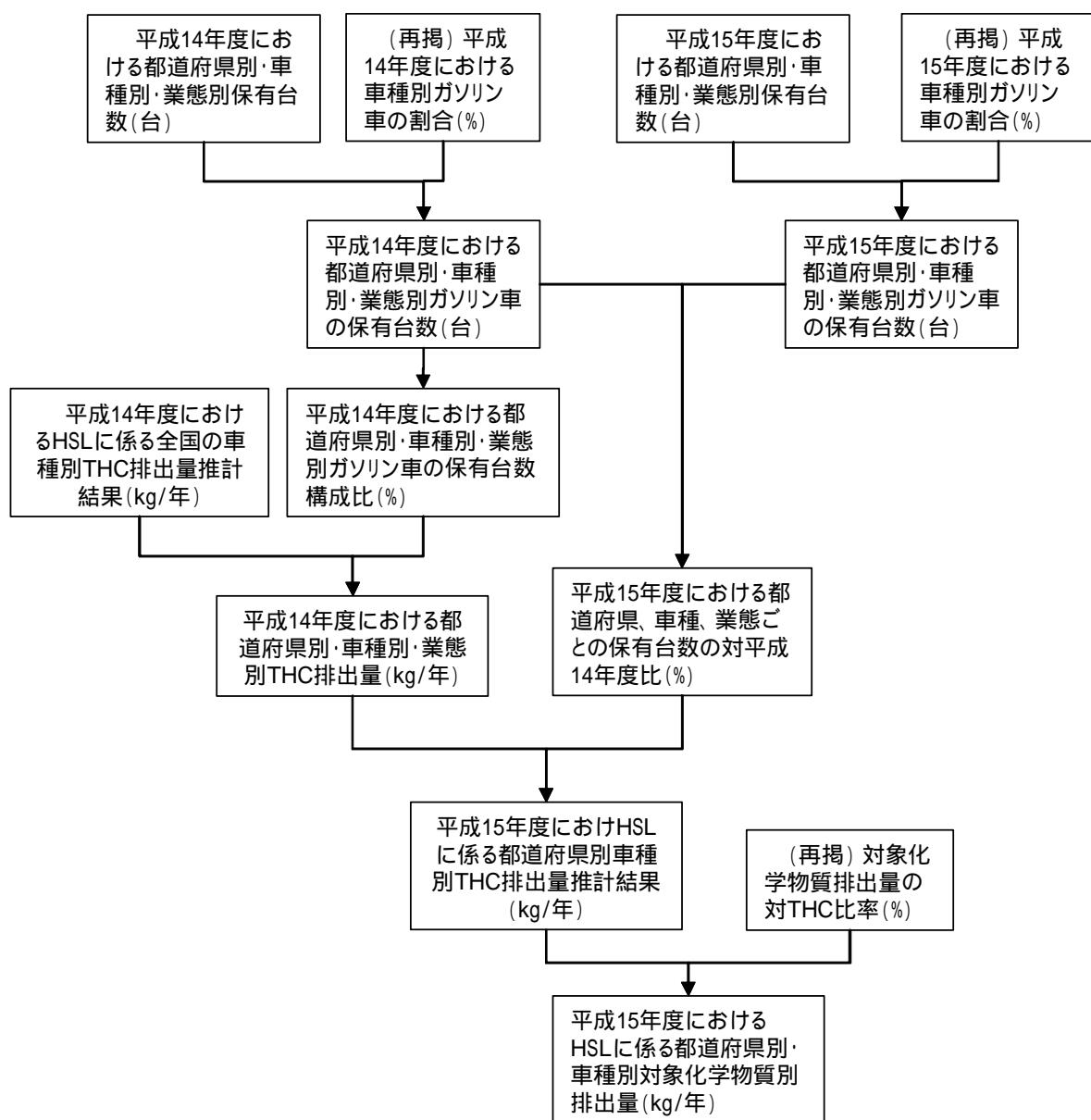
図 12-35 燃料蒸発ガス(HSL)に係る対象化學物質別排出量推計フロー
