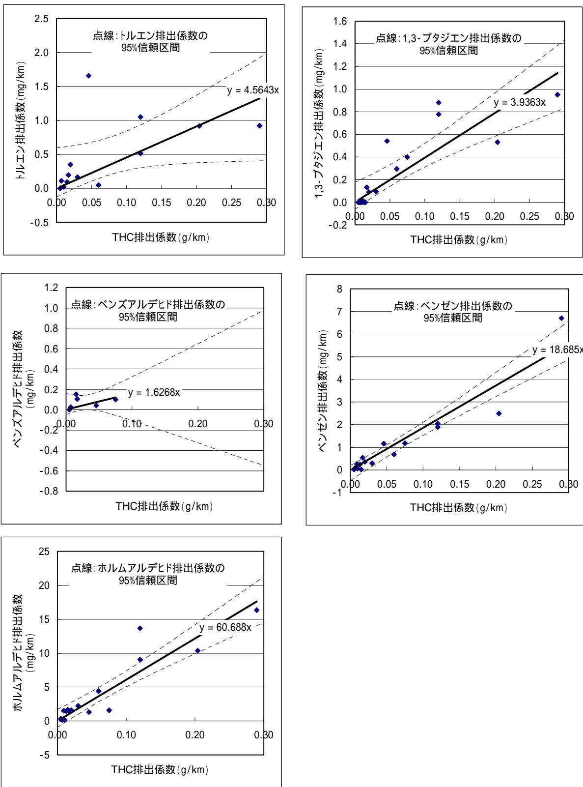
図 12-42 ディーゼル自動車(ホットスタート:重量車以外(触媒あり))に係る
