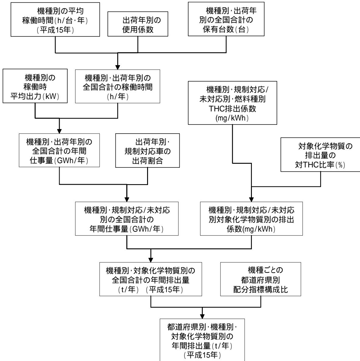
図 12-32 自動車(サブエンジン式機器)に係る排出量の推計フロー
