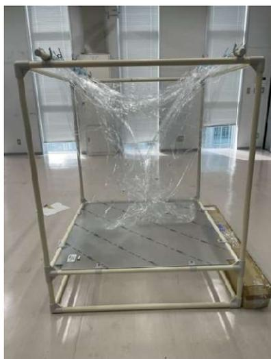
Fig.7 FEP 製スモッグチャンバー
