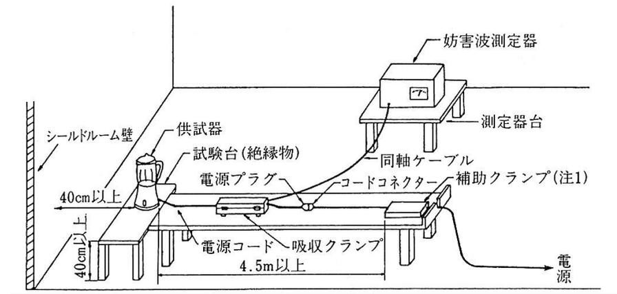
図3-18 雑音電力測定配置例
