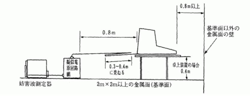
(水平金属基準面を使用する場合)
