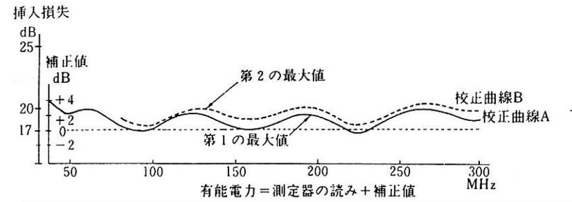
図 5-10 吸収クランプ校正曲線の例
