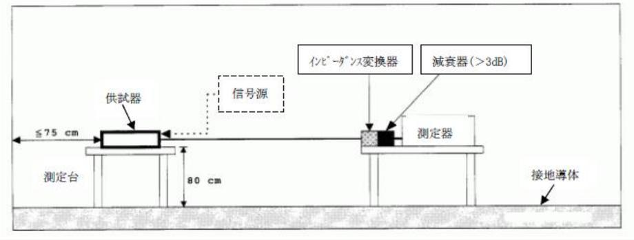
図 8 - 3 RF機器の出力レベル測定配置
