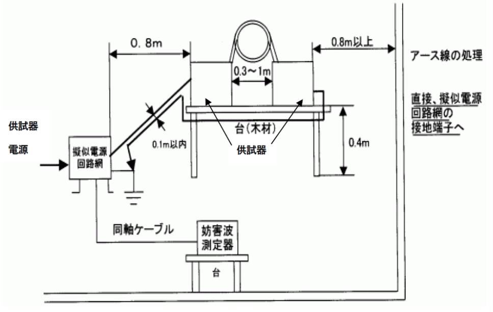
床置型のものにあつては、シールドルーム上にて3mmの厚さのゴム又はプラスチック製の絶縁シートの上、あるいは高さ10cm±25%の非金属製支持台（搬送用パレット等）の上に置いてよい。
