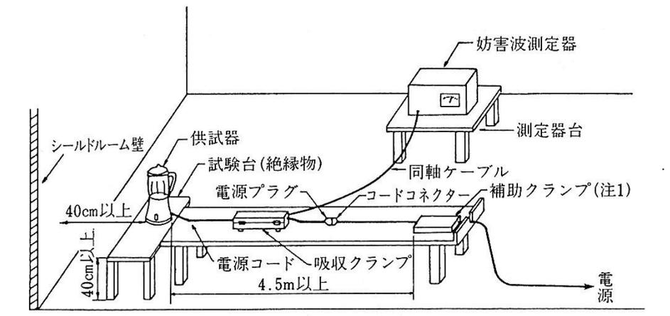
(注) 供試電源と供試器の電源入力との間の高周波の分離度が不十分な場合、供試器より約4m離れた位置に補助クランプを置き、電源線から入ってくる外部雑音を軽減し、負荷インピーダンスの安定性を改善することができる。
