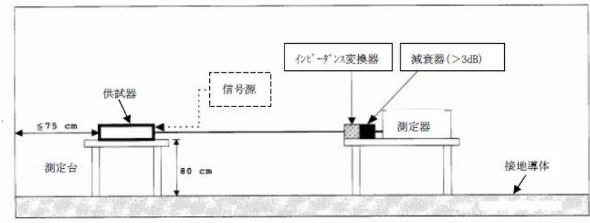
図8-4 漏えい電波の測定配置
