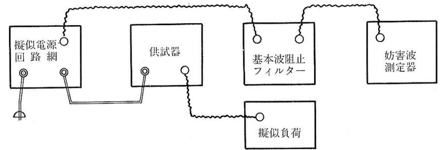
(注) 強力な高周波数出力が回路網より直接測定器に入力されるとエラーを生じるので高域阻止のフィルターを中間に入れて、測定対象のスプリアスだけを測定する。
