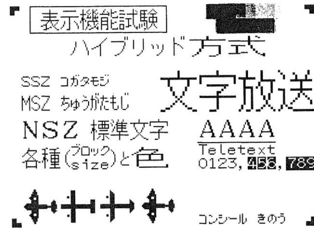
図 3-16.1 文字多重アダプター試験用信号
