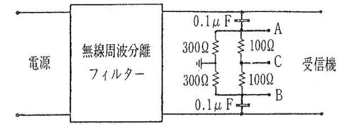
図 3-10 擬似電源回路網の基本回路
