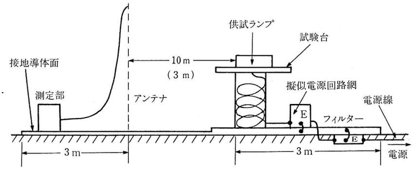
(注) 測定用アンテナの中心に、水平距離で最も近い供試器の端面を、
