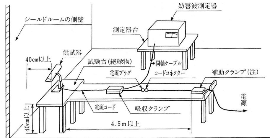
図7-1 雑音電力測定配置例
