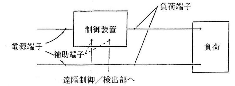
図 5 - 9 2 端子制御装置の測定方法
