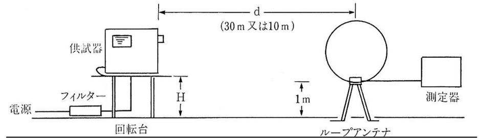
図2-1 526.5kHz-30MHzにおける測定
