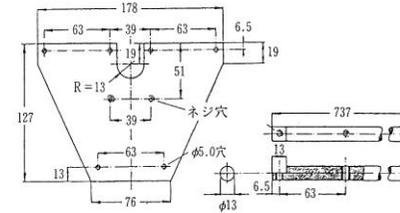
図3-4 受信側ダイポールの構造
