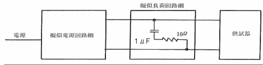
図 2-3 搬送式インターホンの擬似負荷接続方法 (例)
