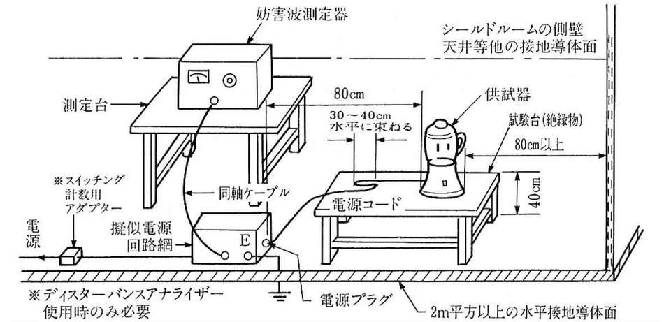
図5-2 雑音端子電圧測定配置例（床を基準接地導体面とする場合）
