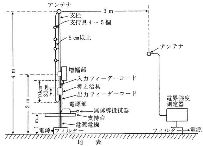
(備考) 1. 支柱は直径が3cm、長さが4mの金属性のものとする。
