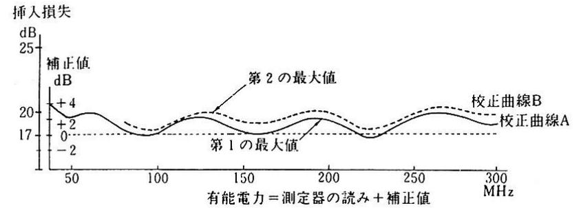
図 3-19 吸収クランプ校正曲線の例
