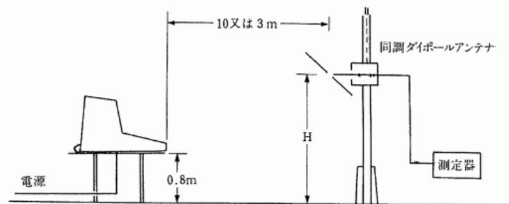
受信アンテナの高さHは、1～4mの範囲で変化させる。
