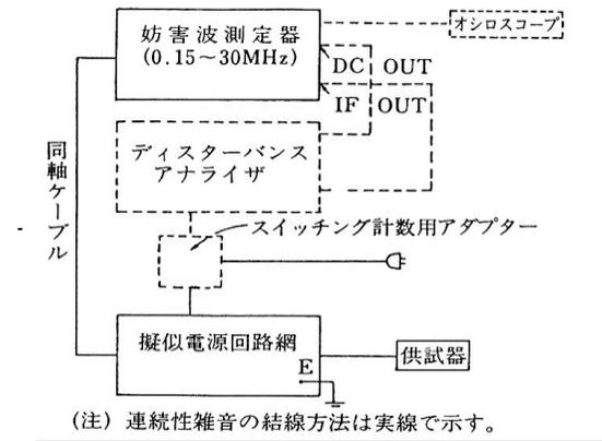
図 5-11 0.5MHzから30MHzまでの測定
