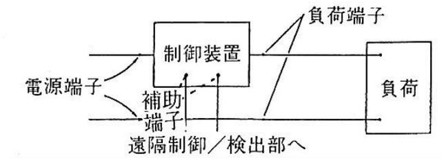
図 7-7 2端子制御装置の測定方法
