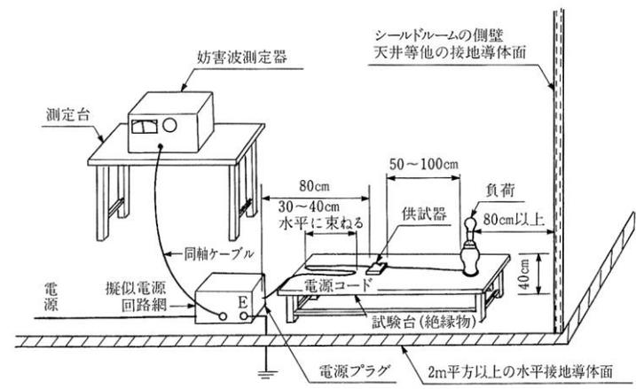
図 7 - 4 雑音端子電圧測定配置例
