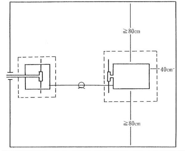
図 3-9 電源線に誘起される雑音端子電圧の測定 (図 3-8 を上から見た図)
