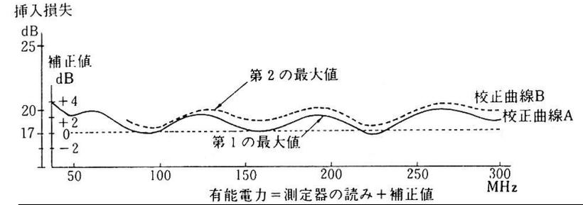
図7-2 吸収クランプ校正曲線の例
