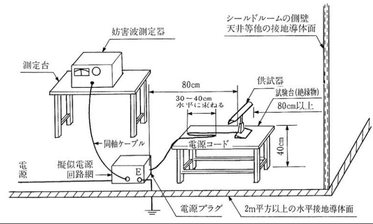
図 7 - 3 雑音端子電圧測定配置例
