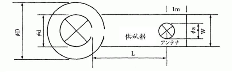
$D = d + 2m$ 、 $d$  = 供試器の最大寸法
