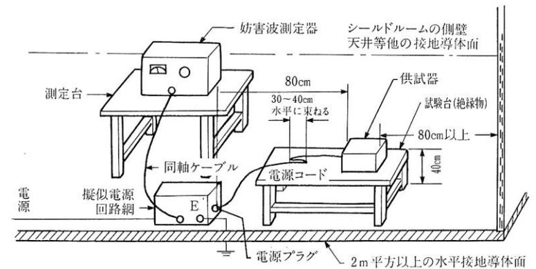
図 2-4 雑音端子電圧測定配置例
