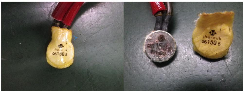
構造試験において、通常の使用状態（平常温度上昇試験：100V50Hz）でポンプモーターに内蔵された過負荷保護装置が動作した。
