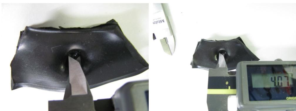
材料試験において、消磁用巻線を保持する絶縁物（巻枠）を温度上昇値（91.5K）に40℃を加えた131.5℃の恒温槽に入れ、直径が5mmの鋼球を用いて20Nの静荷重を1時間加えた後に測定したへこんだ穴の直径が4.0mmであった。
