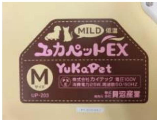
消費電力の許容差試験において、表示の定格消費電力25Wに対して、電源電圧が100Vのときに測定した測定値が30.2W(電源周波数60Hz、偏差:20.8%)であった。
