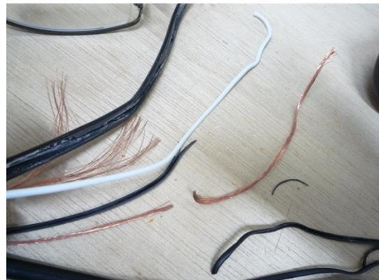
電源接続及び外部可撓コードにおいて、コードの折り曲げ試験を行った結果、各導体の断線率が100%であった。
