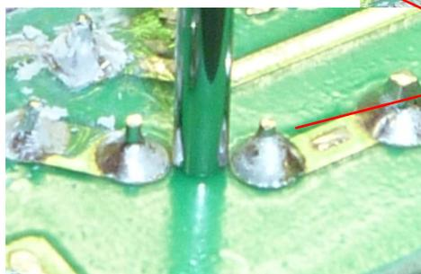
構造試験において、プリント基板（印刷配線）の100V異極充電部相互間（電流ヒューズF1）の空間距離が2.1mmであった。
