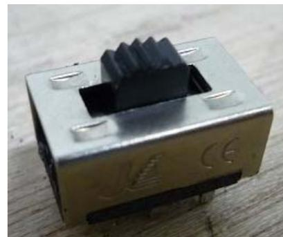
構造試験において、回転方向切替スイッチ部の100V異極充電部相互間の空間距離（沿面距離を含む：その他の箇所）が次のとおりであった。
