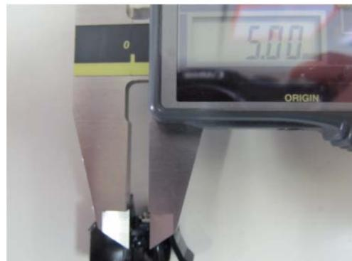
耐熱性試験において、機器用インレットの充電部保持部にボールプレッシャー試験（125℃）を行ったとき、へこんだ穴の直径が5.0mmであった。
