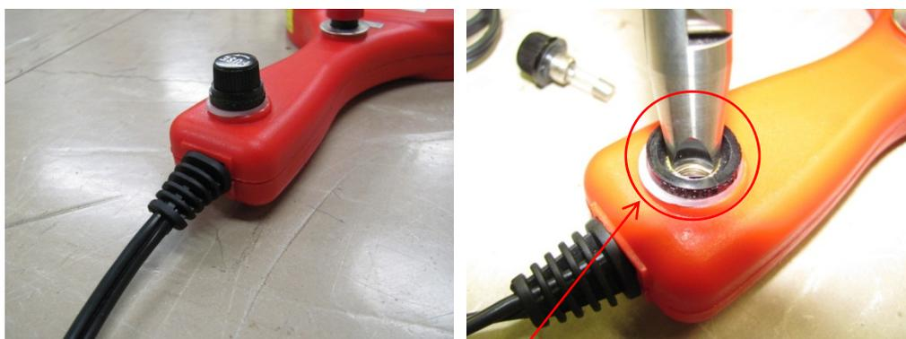
構造試験において、手で容易に取り外すことの出来るヒューズホルダーのキャップを外したとき、ヒューズホルダー内部の充電部に試験指が触れた。
