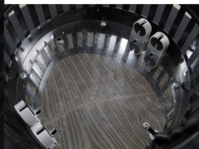
構造試験において、放電ランプの近傍又は外郭の見やすい箇所に適用ランプの種類が表示されていなかった。
