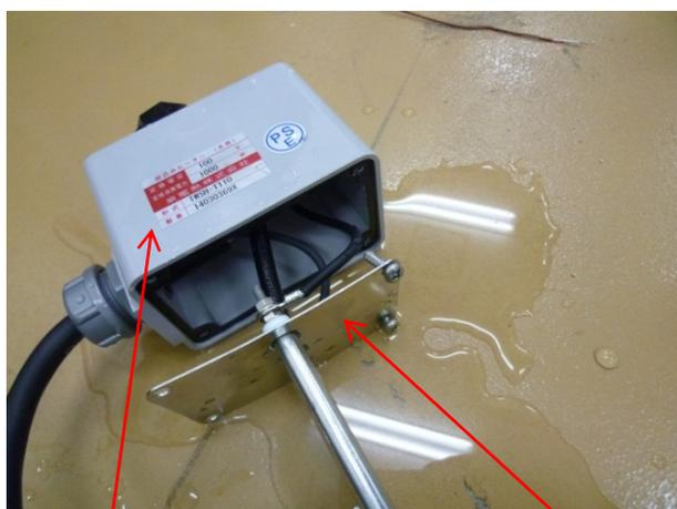
コントローラーケースからヒーター取付金属板を取り外した状態
