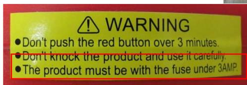
構造試験において、交換が可能である電流ヒューズが「3A」であるにもかかわらず、銘板にある定格電流の表示が「the fuse under 3 AMP」であった。
