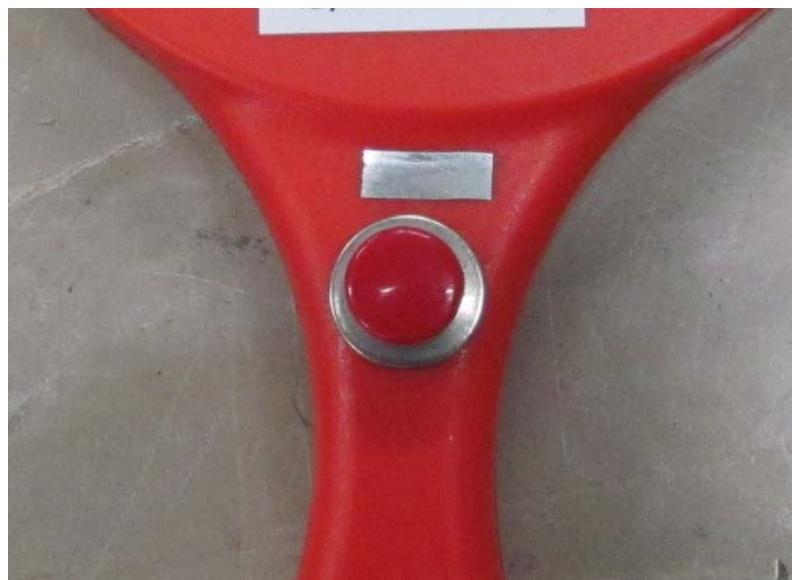
構造試験において、器体スイッチにスイッチの動作状態を示す表示がなかった。
