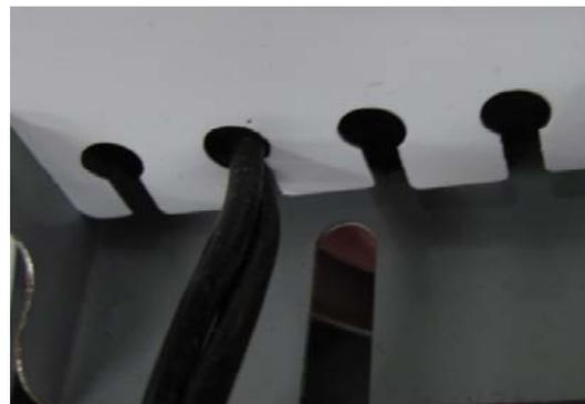
構造試験において、安定器口出し線を通して安定器の金属貫通孔が鋭利であるため、電線の被覆が損傷した。
