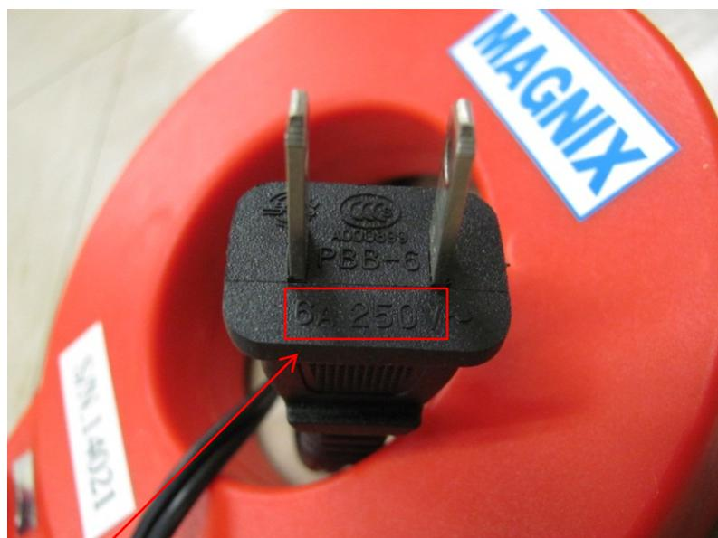
部品及び付属品試験において、差し込みプラグ刃の形状が別表第四6（1）ニ（ホ）aの表1に掲げる125V15A以下のものにもかかわらず、250V6Aの定格表示であった。
