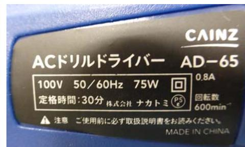
平常温度上昇試験において、使用中に人が容易に触れるおそれのある外郭（合成樹脂製）の温度が88.5℃（50Hz、周囲温度29.5℃）であった。
