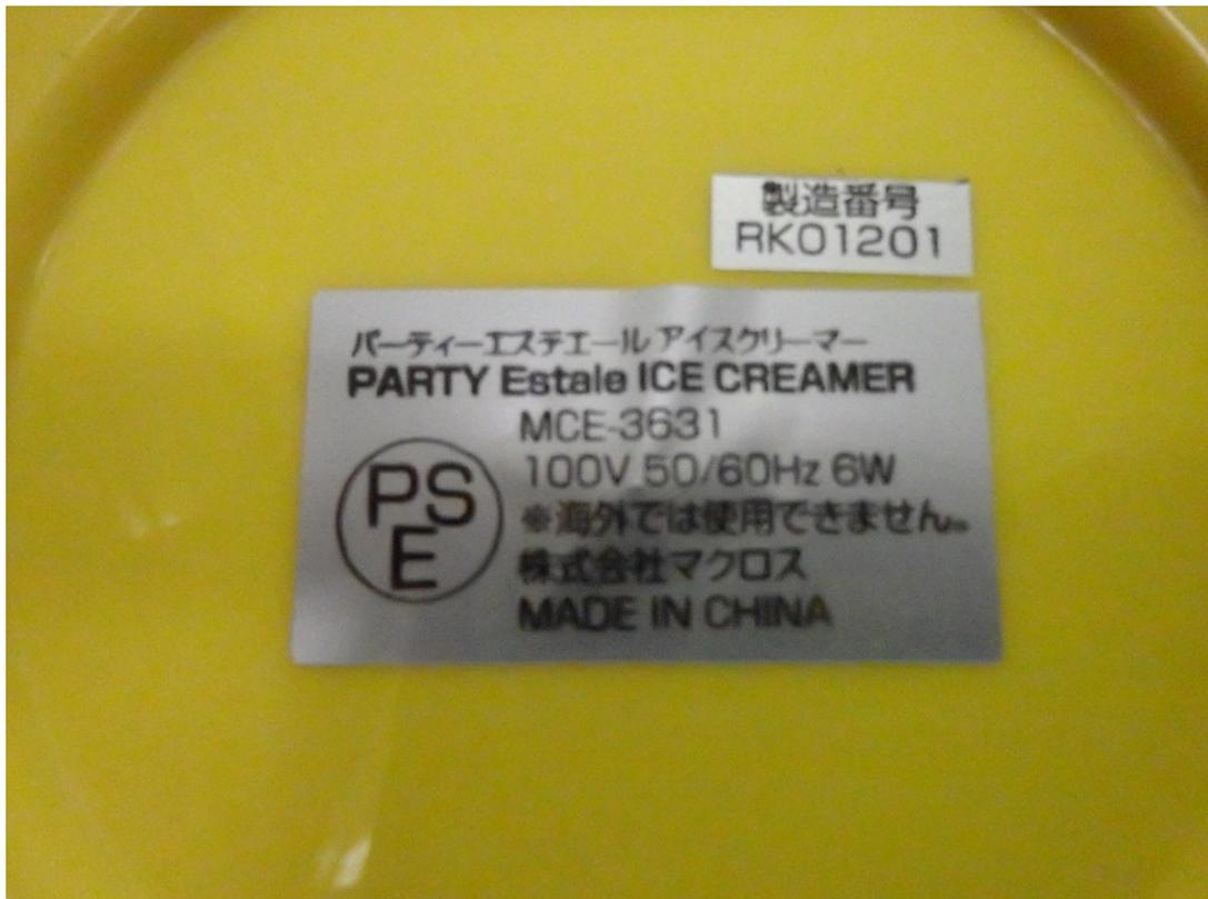
電気用品安全法施行規則第17条(表示の方式)において、当該製品の電気用品名は、使用上「アイスクリームフリーザー(商品名:パーティーエステールアイスクリーマー)」として、適合性検査の特定電気用品の対象品であるにもかかわらず、表示銘板には特定電気用品に要求されている表示(Ⓓ及び検査機関名)が行われていなかった。
