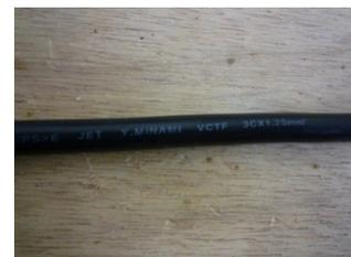
部品において、機器に流れる最大電流が16.5A（ACアウトレット14.5A + 2A）であるにもかかわらず断面積が1.25mm<sup>2</sup>（12Aまで）の電源電線及び125V 12Aの電源プラグを使用していた。
