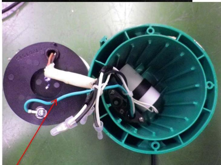
構造試験において、器体内部のアース用口出し線（電源電線の1線）にアース用である旨の表示がなかった。
