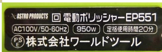
構造試験において、通常の使用状態（平常温度上昇試験：100V、50／60Hz）で過負荷保護装置が動作して停止したのち、過負荷保護装置が自動復帰したため、予期しない可動部の動作があった。
