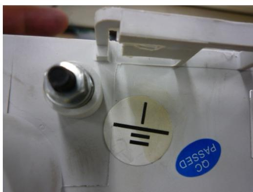
材料試験において、アース端子（外部）の材料が鉄製であった。
