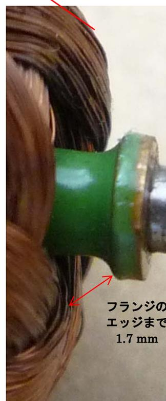
構造試験において、電動機の回転子巻線（充電部）と回転子鉄心及びシャフト（アースに接続）との間の空間距離が1.3 mm及び1.7 mmであった。
