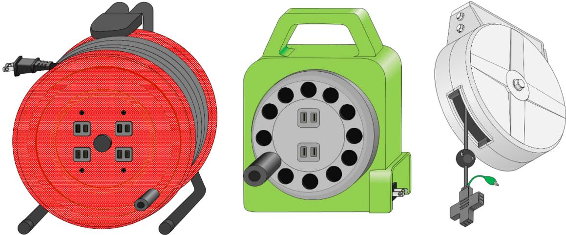
「コードリール」とは、電源電線を収納する巻取り機構を有し、当該機構又は電源電線の先端部に接続器が付属されるものをいう。(範囲等の解釈 二 3. 3 (14))
