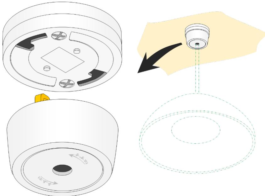
天井などの造営材に取り付けて使用するもので、ふたにコード取り付け端子を兼ねた引掛接触刃を有し、器台に取り付けた電線取り付け端子を兼ねた引掛け接触刃受に、ふたを回しながら引掛けて接続するもの。
