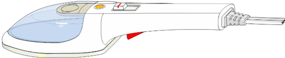
電熱により蒸気を発生させ、衣類、繊維などのしわ取り等に使用するものをいう。熱板を有するいわゆるスチームアイロンは、「電気アイロン」として扱われる。
