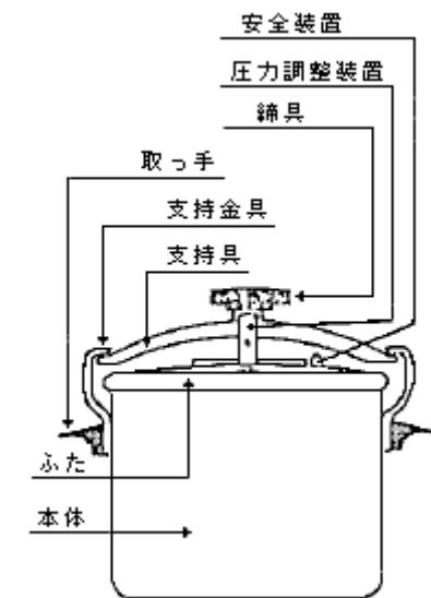
2 現在使用されている圧力調整装置及び安全装置の名称の参考例は、次のとおりである。
