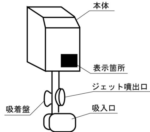
図 6-8-3 循環装置本体への表示の例
