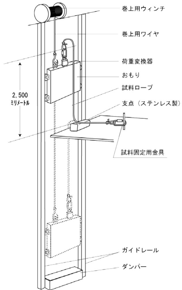
図4-3 衝撃試験装置の参考例
