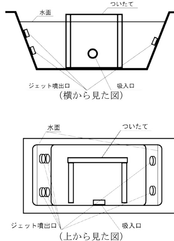
図6-5-1 ジェット噴流機能等の影響を少なくさせる措置の例 (ついたてを用いたもの)
