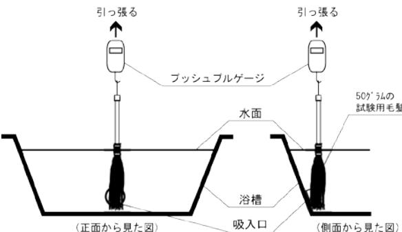
図 6-7-1 吸入口の中心から鉛直方向上向きに引っ張るときの例
