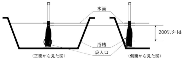
図 6-4 試験用毛髪を吸入口に置く例
