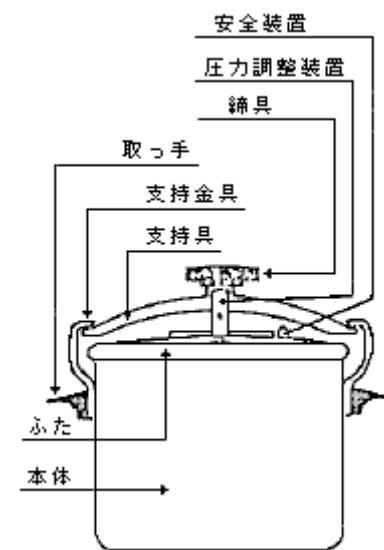
2 現在使用されている圧力調整装置及び安全装置の名称の参考
