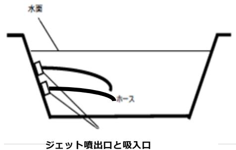
図 6-5-2 ジェット噴流機能等の影響を少なくさせる措置の例（ホースを用いたもの）
