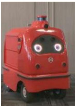
モバイルオーダーシステム・エレベーターと連携し、オフィスビルテナント内をロボットが走行の上、フードデリバリーを実施
