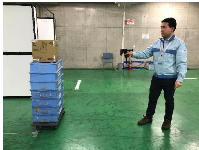
図 2-25 ハンディリーダーによる段ボール箱貼付電子タグの単品読取り実験風景(写真)
