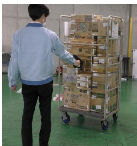
図表 2-33 ハンディリーダーによる段ボール箱貼付電子タグのカゴ車一括読取実験風景(写真)
