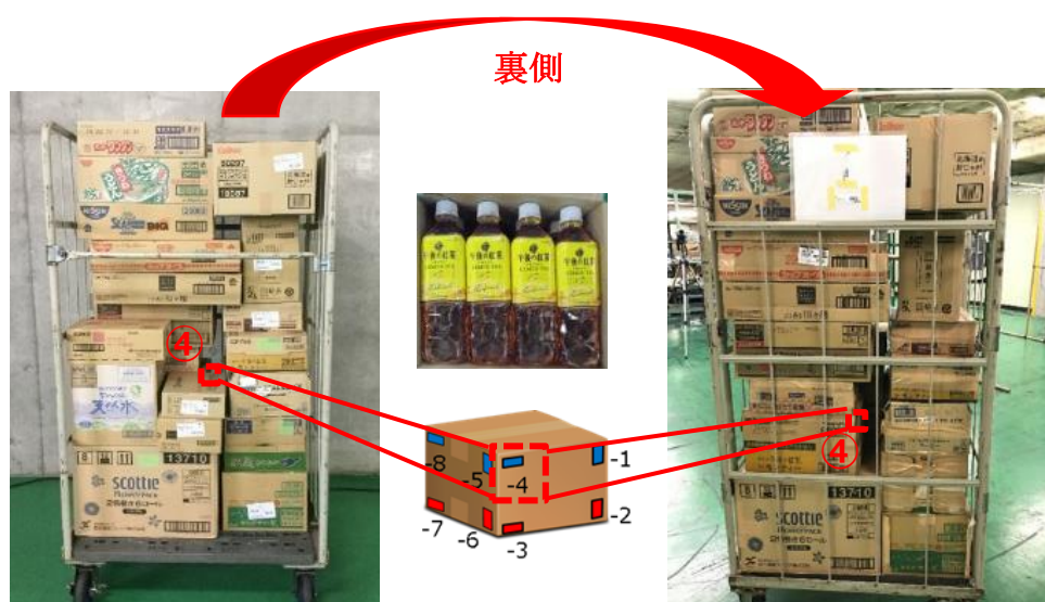
図表 2-48 ゲート型リーダによる段ボール箱貼付電子タグ一括読取率の低い箇所④(写真)
