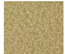
図 1 人工物メトリクスの例 (半導体表面パターンの測定値)
