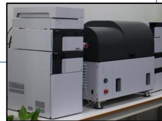
流動場分離法（FFF）を用いた装置
