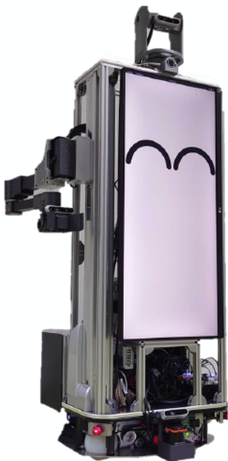
(応用例) TriOrb BASEとAIを組み合わせた 見守りロボ (SABOTICS)
