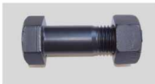
図2 塩水噴霧試験 4000 時間後の製品
