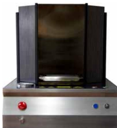
図 2 - レーザスポット周期加熱放射测温法の測定装置
