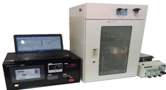
熱硬化樹脂の硬化収縮率連続測定装置
