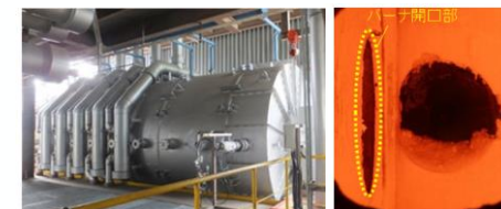
IHI 相生事業所内でのアンモニア専焼試験 左：大型試験設備／右：専焼火炎
