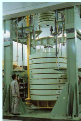
力標準機(力の国家計量標準)の重錘の質量調整と校正
