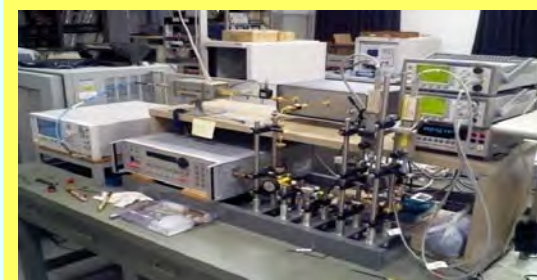
導波管型電力比較校正装置 (75-110 GHz)
