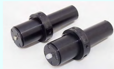
光度用標準LED(手前)と 光束用標準LED(奥)
