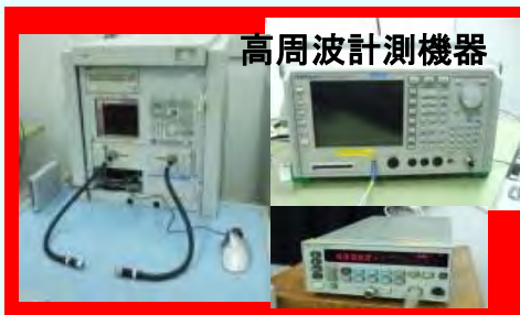
導波管型電力比較校正装置 (75-110 GHz)
