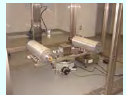
環境分析装置のための標準ガスの調製 (写真: 産総研NMIJ有機分析科 ガス標準研究室)
