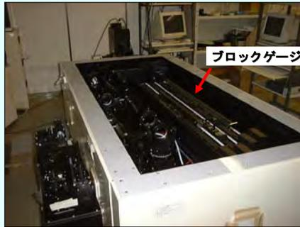
長尺ブロックゲージ校正装置 (レーザー干渉計)
