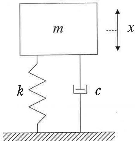
問18 機械が1200 rpmで回転しているとき、回転周期に等しい周期の正弦加振力が鉛直方向に生じている。この加振力を抑制するために機械の重さによるばねの静的たわみが5 mmとなるように減衰のないばねで支持すると、基礎に伝わる力は加振力の何%となるか。最も近い数値を次の中から一つ選べ。
