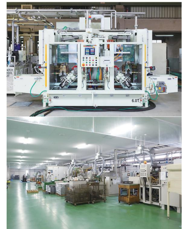
▲マーケットシェア8割を誇る同社主力製品、クランクシャフト焼入設備(上)と明るく冷暖房完備の熱処理工場風景(下)
