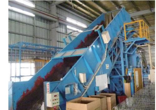
▲古紙のコンベアに取り付けた緊急停止センサ
