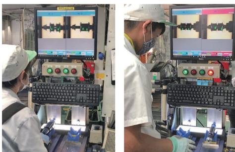
▲内製した画像診断機で熟練工以外でも検査工程が可能に
